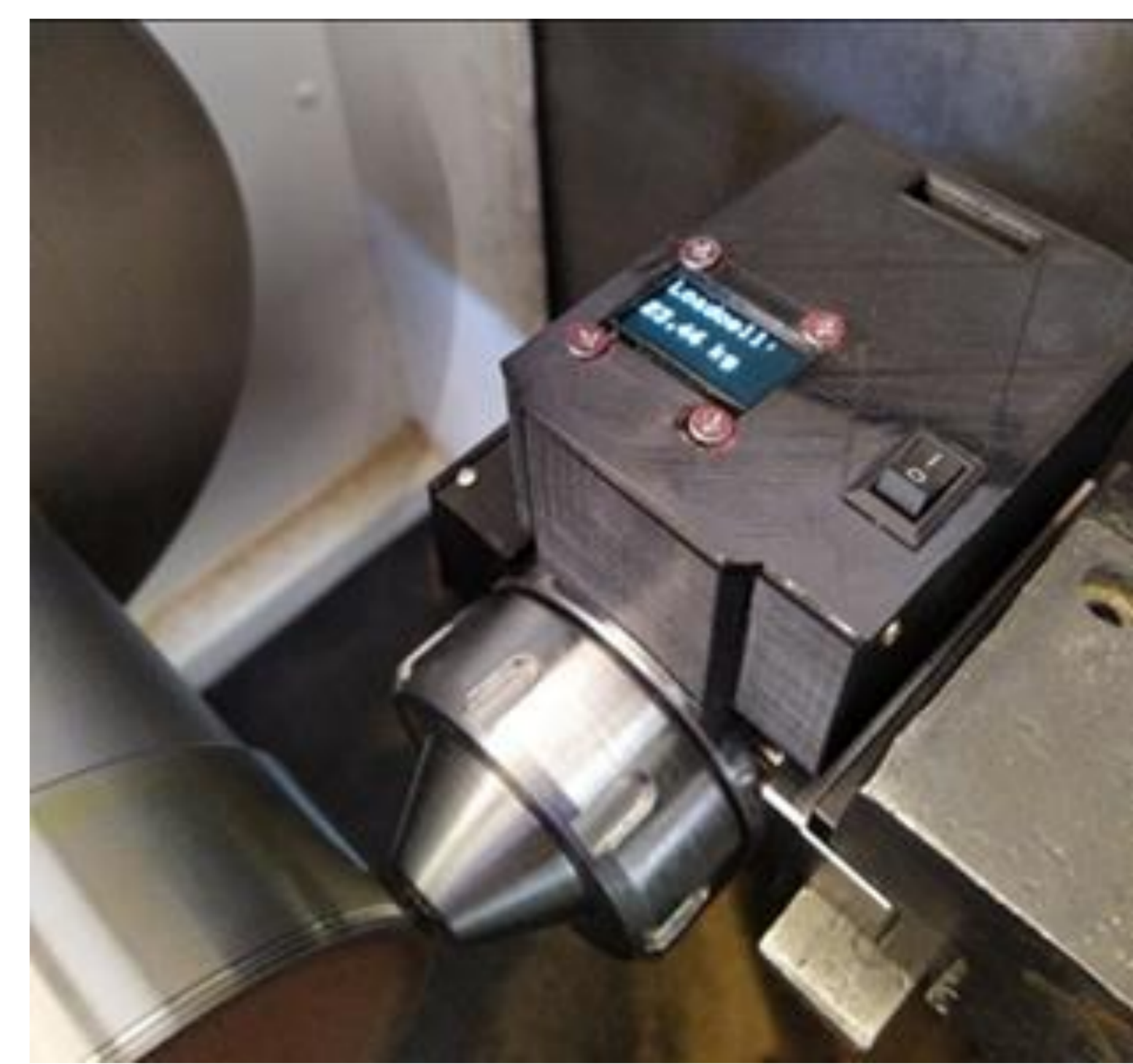
Фиг. 1. Инструмент за ППД с възможност за измерване на деформиращата сила: а) конструкция на инструмента; б) по време на обработване на ротационна повърхнина чрез ППД на стругова машина с ЦПУ.
